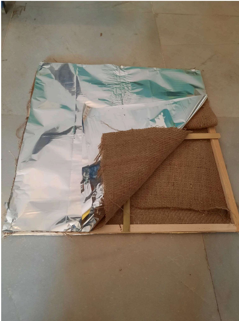
Fig 37.8.2.1.1-3 : Actual cross section of MLP Static Panel
