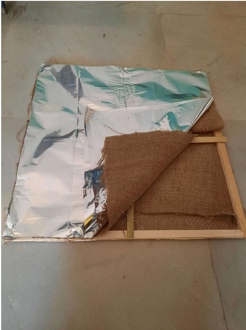
Fig 37.8.2.1.1-3 : Actual cross section of MLP Static Panel
